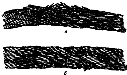
Рисунок 3. Обрывы проволок в зоне уравнительного блока:
