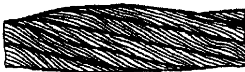
Рисунок 13. Местное увеличение диаметра каната.
