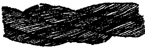
Рисунок 1. Обрывы и смещения проволок каната крестовой свивки.
